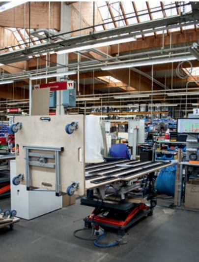
Ergonomischer Arbeitsplatz in der Tisch- und Korpusmontage
