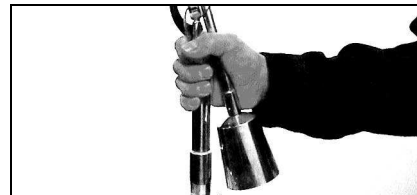
Falsch ! nicht den Leuchtenarm umfassen!
